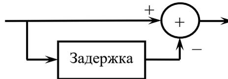
Рисунок 1 - Структурная схема однократной системы ЧПК
