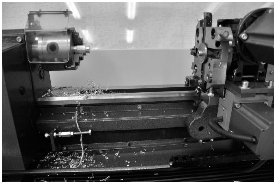
Рис. 1. Малоразмерный станок с ЧПУ производства фирмы «Реабин»
