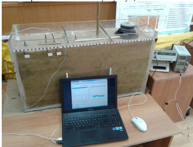
Рис.1 - Внешний вид экспериментальной установки для исследования влияния различных факторов на проявление сейсмoeлектрических эффектов
