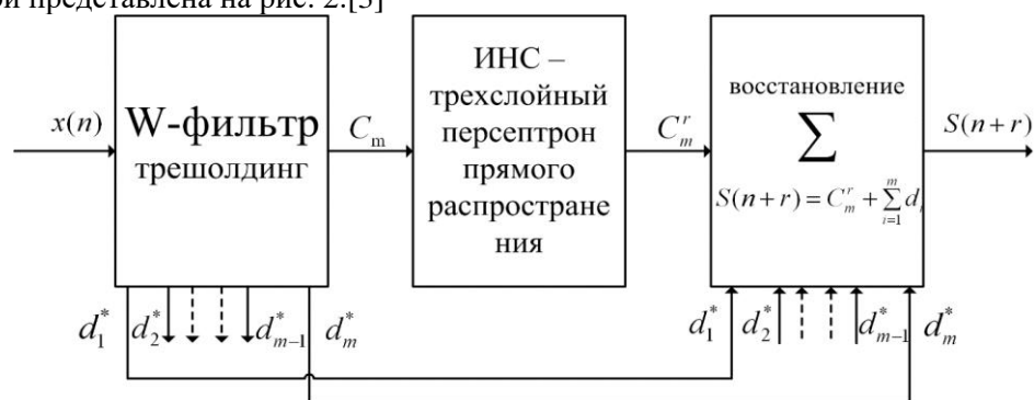
Рис. 2. Структурная схема нейросетевого прогнозирования изменений значений стоимостных показателей
