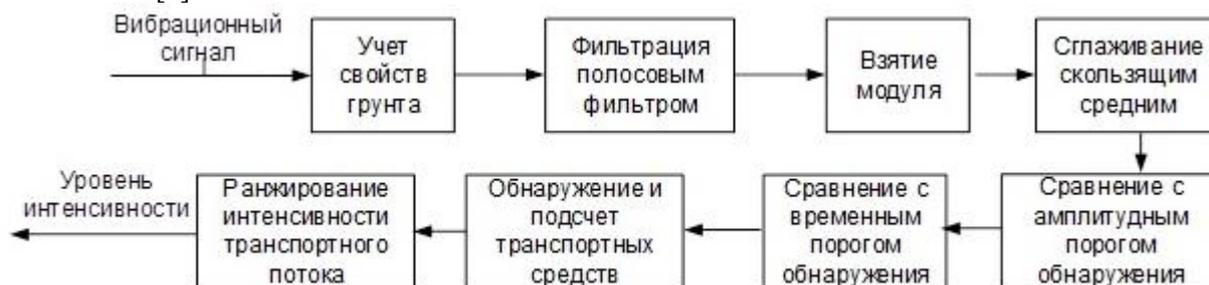
Рис. 1. – Структурная схема алгоритма определения интенсивности.
