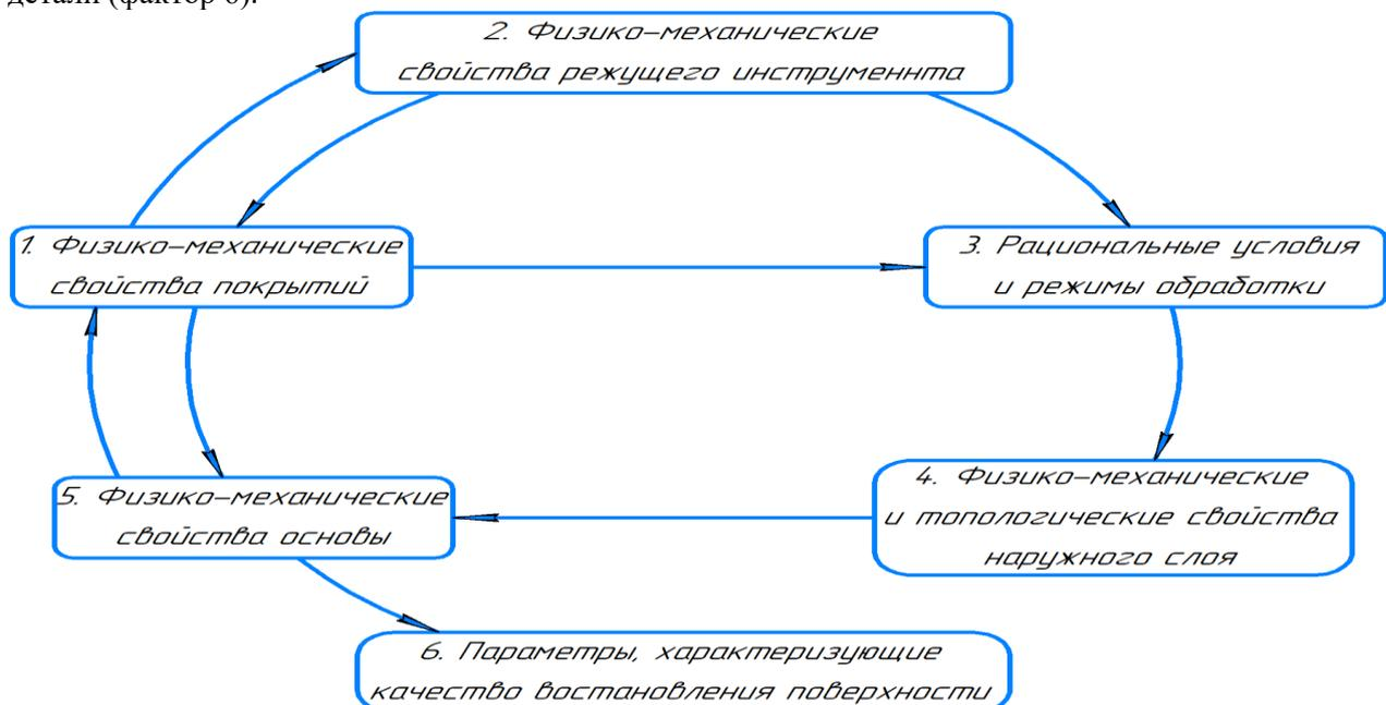
Рисунок 1 Схема связи факторов, обеспечивающих формирование исходных слоев твердого железа
