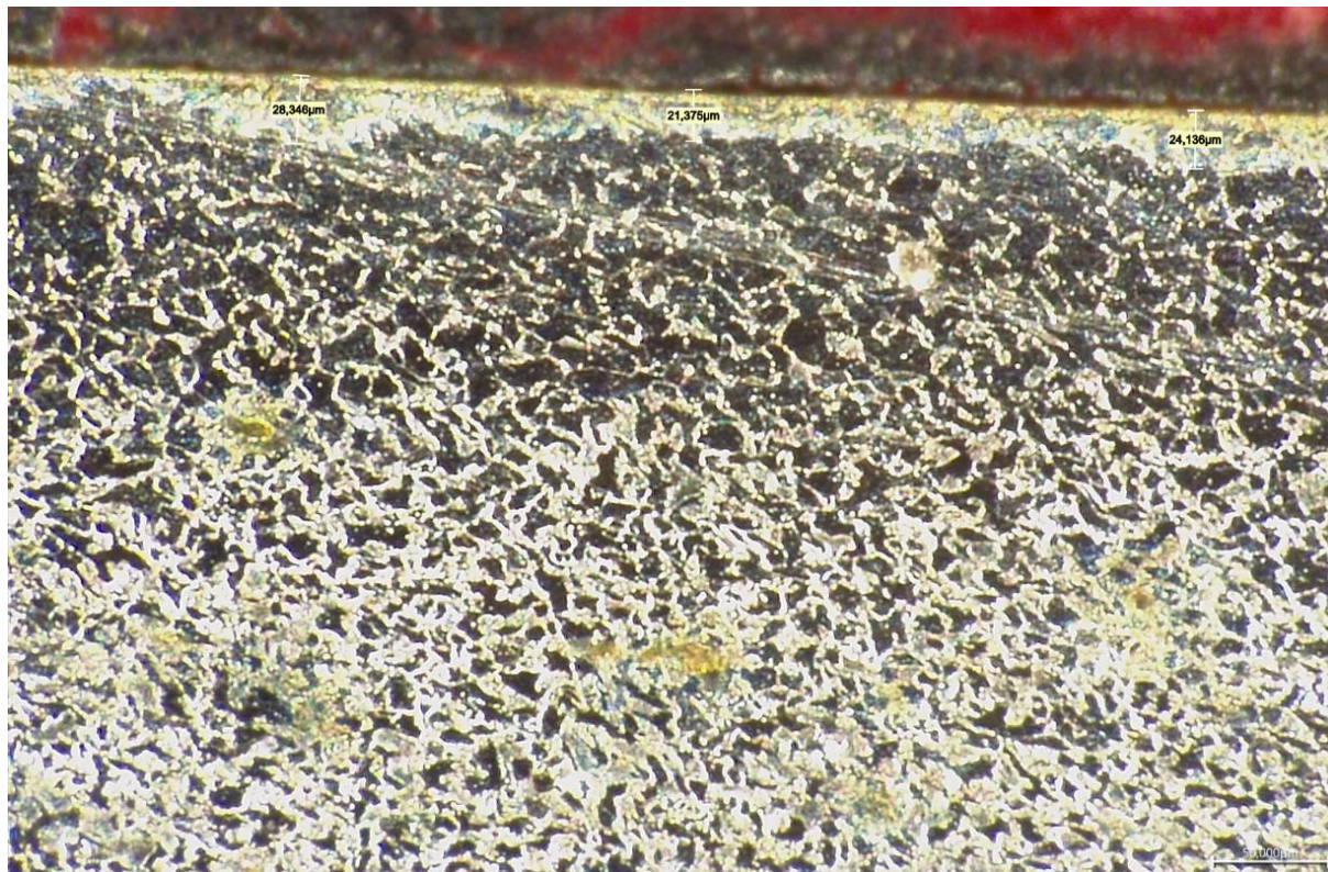
Рис. 1 Упрочненный слой образца из стали 40Х, с K=0,8 , \times 700 .
