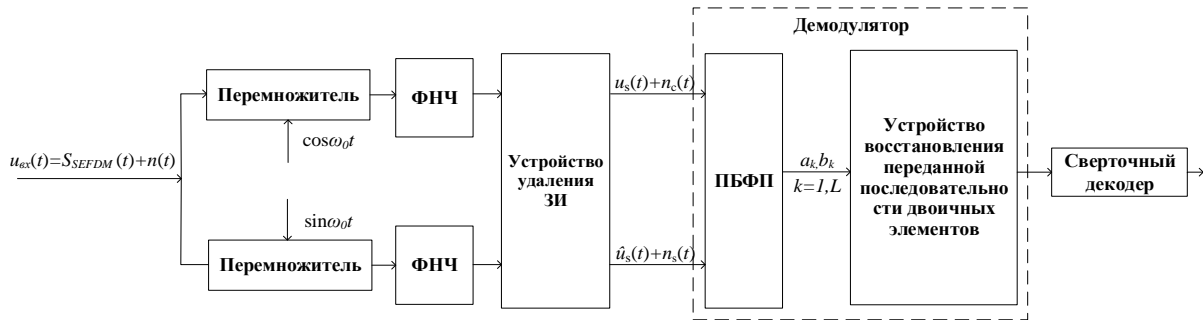
Рис. 2. Структурная схема приемника SEFDM-сигналов
