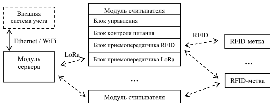
Рис. 1 – Структурная схема системы радиоидентификации на основе технологий RFID HF и передачи данных по технологии LoRa.
