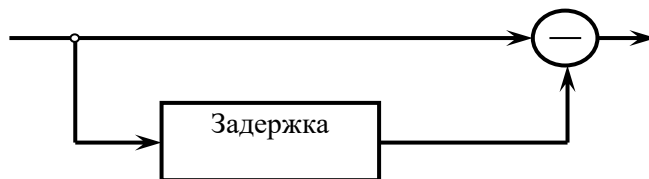
Рис. 1. Структурная схема однократной системы ЧПК
