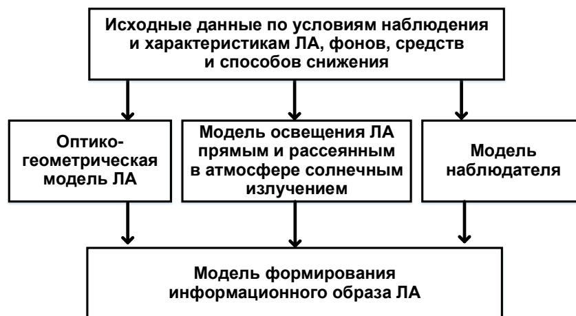
Рис. 1. Структурная схема формирования фотометрических изображений ЛА в оптическом диапазоне длин волн
