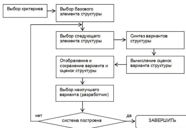
Рис. 1 – Алгоритм принятия решения по формированию структуры устройства.
