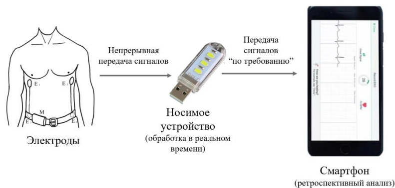
Рис. 1. Принципиальная схема системы непрерывного мониторинга биосигналов
